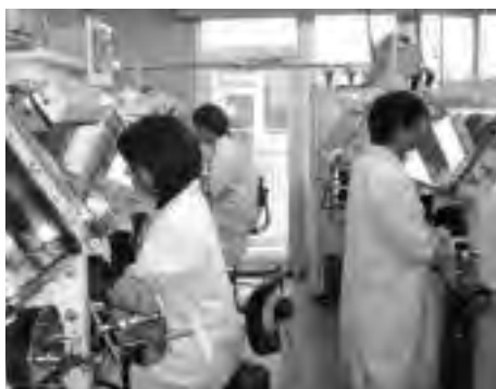
写真 空気中の水分などと化学反応を起こさないように、特殊なガスを充満させたグローブボックスという箱の中に固体の電解質を入れ、実験を行う
