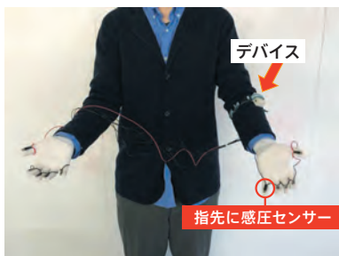
図2 感圧センサーを用いたウェアラブル入力デバイスの開発
