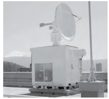
写真 山梨大に設置された最新鋭の気象レーダー。雨粒の形状までも観測が可能で、精度の高い降水予測が出来る
